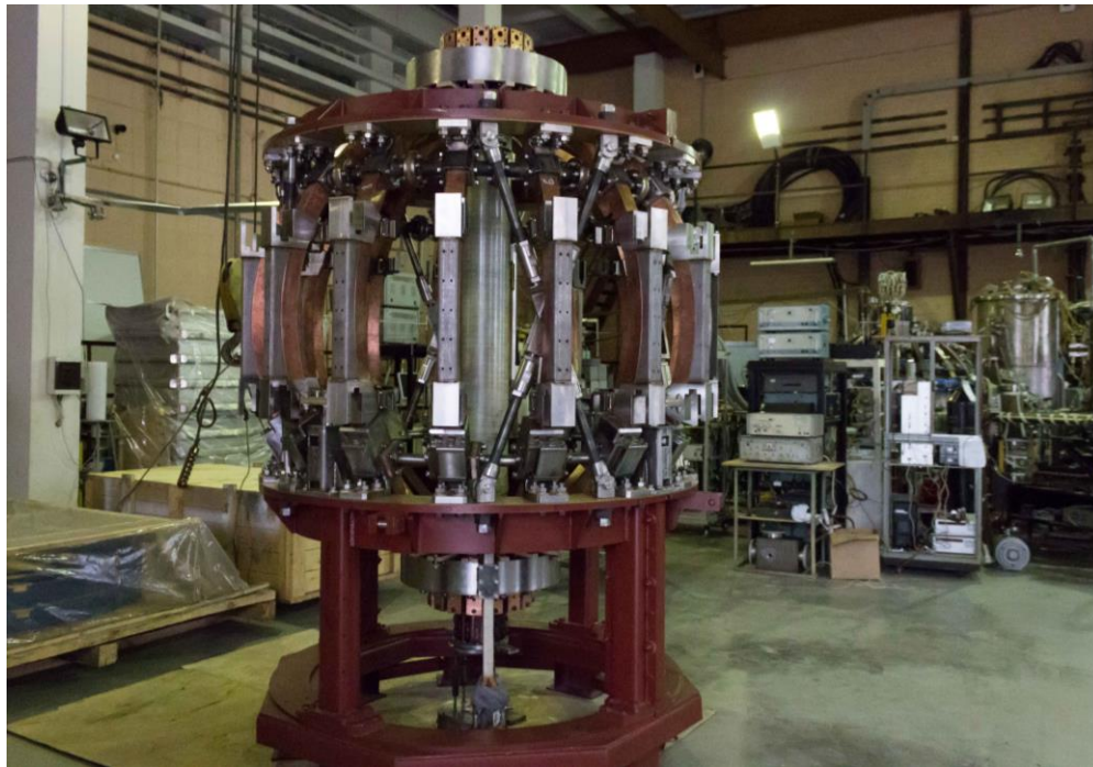
Рисунок 1 – Фотография электромагнитной системы установки Глобус-М2 в экспериментальном зале
