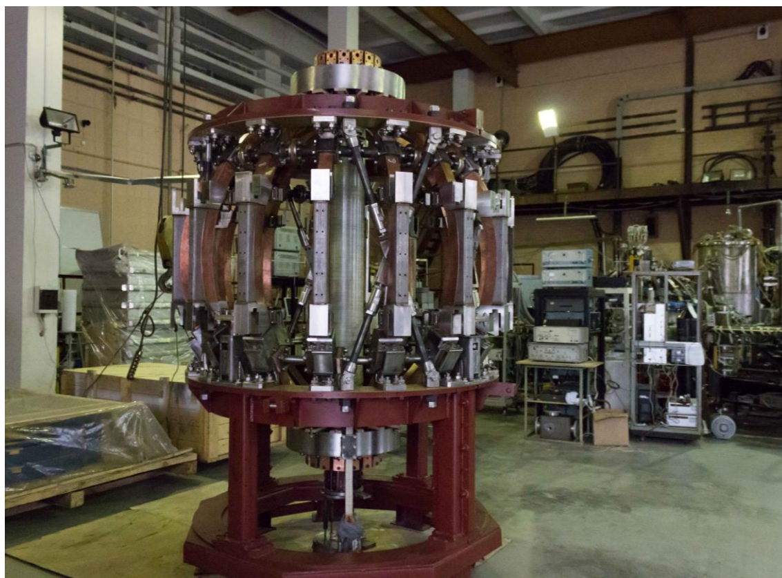
Рисунок 1 – Фотография электромагнитной системы установки Глобус-М2
